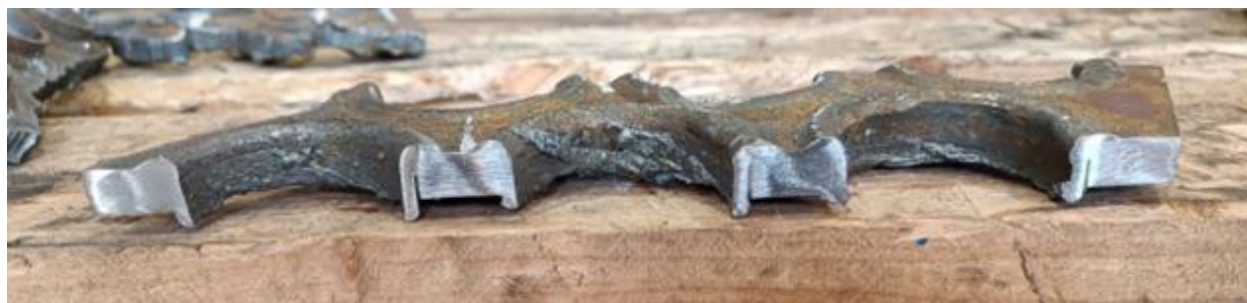
Рисунок 2. Макрошлиф сварного соединения (короткая дуга)
