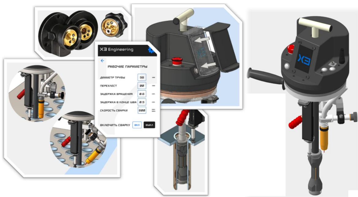
Рисунок 1. Установка орбитальной сварки «Фаворит ХЗ»
