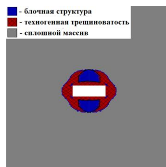
Рис. 3 – Распределение характерных зон нарушения сплошности в окрестности камеры (в ее продольном сечении)
