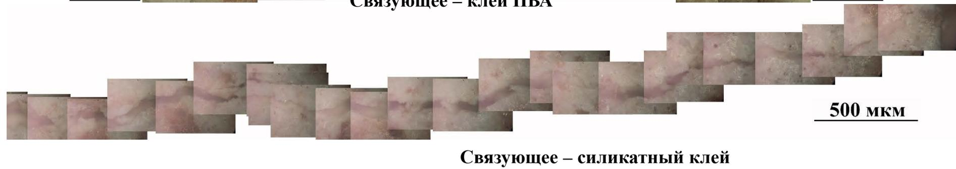
**Рост трещин в образцах из порошка скорлупы
