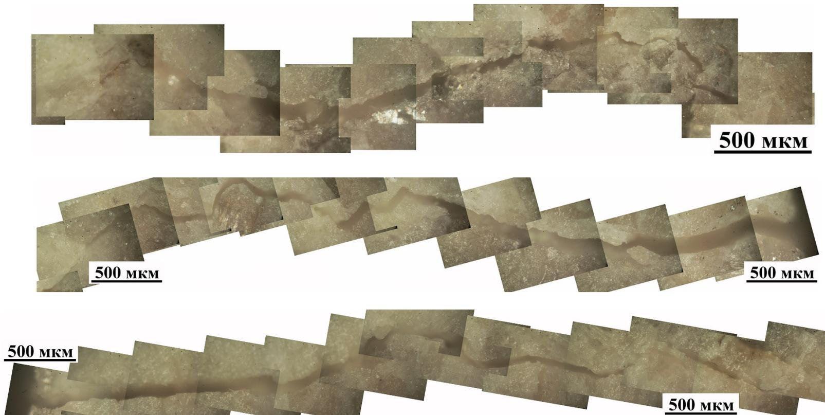
Рост трещин в образцах из порошка скорлупы куриных яиц заторможен, что указывает на значительный вклад вязкости в их деформационное поведение
