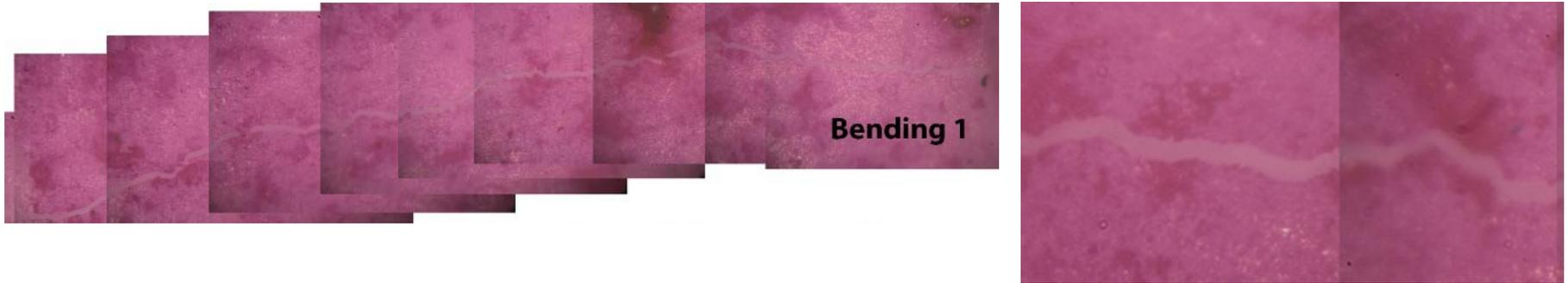
Подрастание трещины при стреле прогиба 100 мкм
